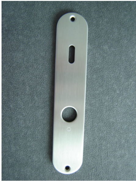
Bild 1: Teil nach 100.000 Abriebhuben mit künstlicher Schweißlösung
